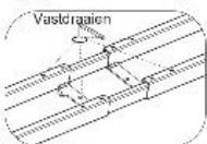
de breedte van het frame kan worden ingesteld op de bladmaat
