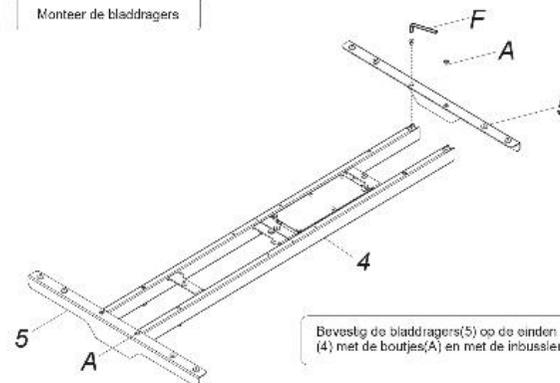
Bevestig de bladdragers(5) op de einden van de telescopische beam (4) met de boutjes(A) en met de inbusleutel(F).
