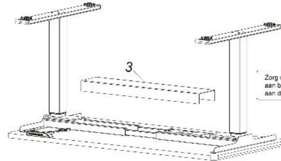
Zorg dat de magnetische kabelhouder (3) aan beiden zijden goed blijft vastzitten aan de metalen beams
